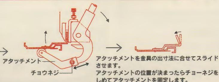
アタッチメントを金具の出寸法に合わせてスライドさせます。アタッチメントの位置が決まったらチョウネジをしめてアタッチメントを固定します。
