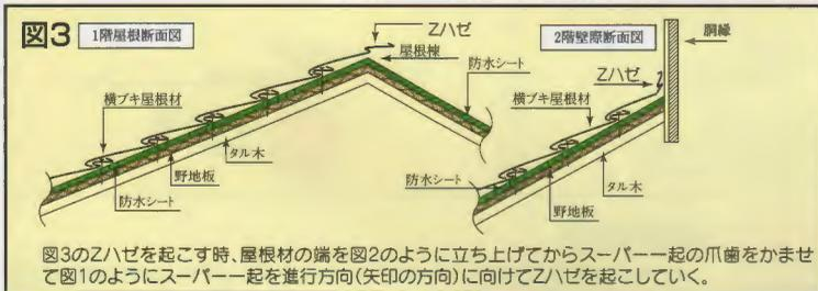
図3のZハゼを起こす時、屋根材の端を図2のように立ち上げてからスーパー一起の爪歯をかませて図1のようにスーパー一起を進行方向(矢印の方向)に向けてZハゼを起こしていく。
