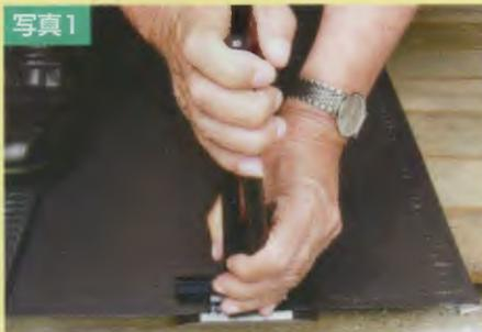
写真1のように巻込ツカミを差し込む。その際、巻込ツカミの首部を片方の手で押さえる。
